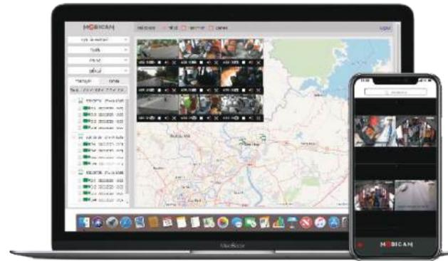
MobiCam là một hệ thống Camera giám sát dành riêng cho ngành Vận tải, hệ thống tích hợp sẵn các module 4G, giám sát hành trình GPS, hỗ trợ kết nối với cảm biến nhiên liệu, cảm biến mở cửa... hệ thống ghi nhận hình ảnh HD hoặc Full HD và được truyền về máy chủ lưu trữ, hỗ trợ công tác quản lý dễ dàng hơn.
